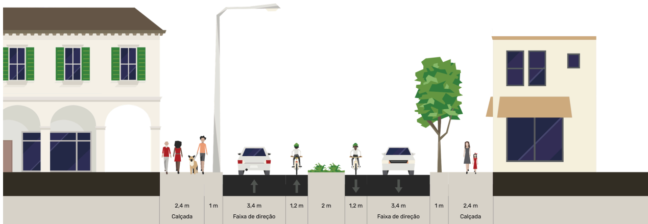
Figura 2: Imagem ilustrativa do sistema viário com ciclovia bidirecional em vias com largura maior de 22m.
